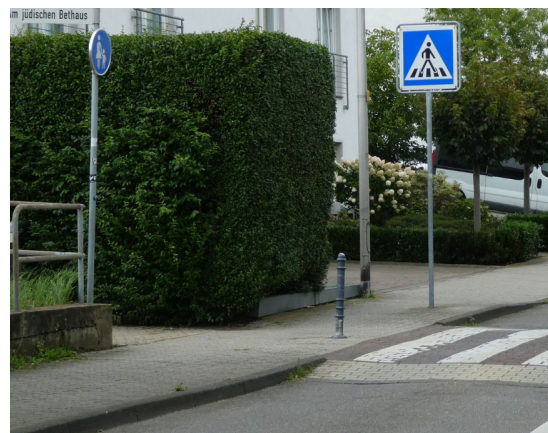
Bild 7: Der fahrbahnunabhängige Weg wird unterbrechungsfrei über die Fahrbahn geführt.
