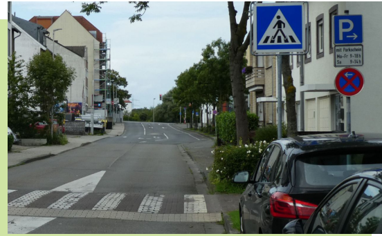
Bild 14 a und 14 b: Parkende Fahrzeuge am Fahrbahnrand oder auf einem Seitenstreifen blockieren die Sicht auf Kinder, Rollstuhlfahrer oder kleine Erwachsene.
