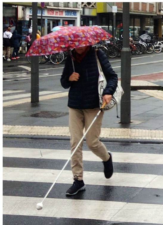
Bild 4: Sehbehinderte Personen benötigen saubere und kontrastreiche Zebrastrreifen sowie Tastkanten am Bordstein.
