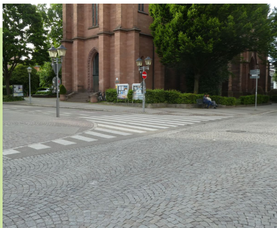
Bild 19: Der Zebrastreifen verlängert den Gehweg über die Einmündung hinweg.
