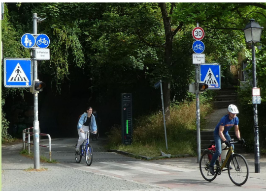
Bild 8: Zebrastreifen über Radwege: links eine deutsche Lösung mit Schilderwald und Warnleuchten, rechts eine einfachere niederländische Lösung
