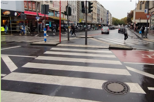
Bild 11: An dieser Kreuzung in Köln wurden die Fußgängerampeln durch Zebrastreifen ersetzt, um unnötige Wartezeiten zu vermeiden.
