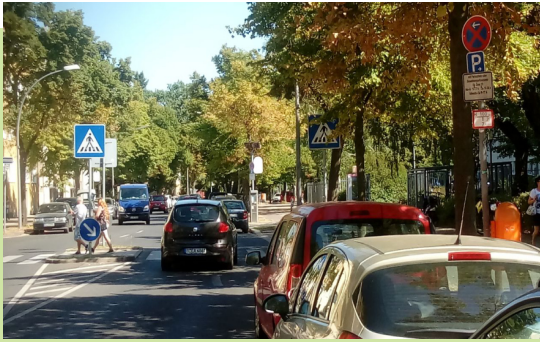
Bild 14 a und 14 b: Parkende Fahrzeuge am Fahrbahnrand oder auf einem Seitenstreifen blockieren die Sicht auf Kinder, Rollstuhlfahrer oder kleine Erwachsene.
