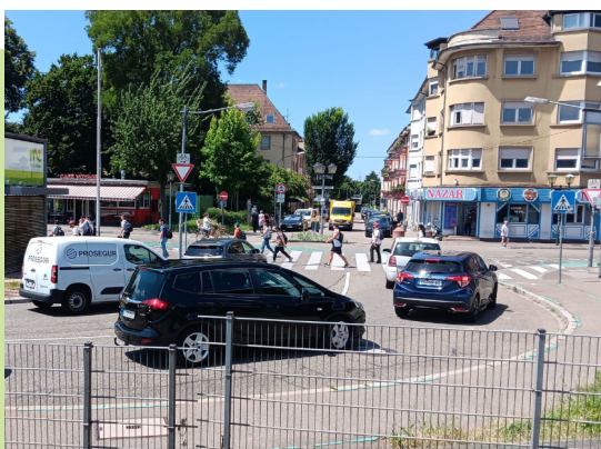
Bild 2: Zebrastreifen über mehrere Fahrstreifen sind aktuell nur an Einmündungen mit Wartepflicht erlaubt.
