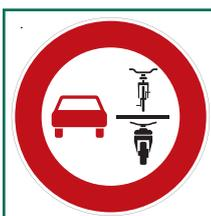
Zeichen 2771 ist erst am Ende des Radfahrstreifens und Beginn des Schutzstreifens aufzustellen, um Zweifel an einem möglichen Überholvorgang durch Abgrenzung eines Sonderweges, der nicht Bestandteil der Fahrbahn ist, zu vermeiden.
