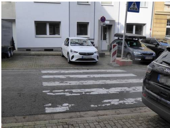
Bild 14: Zu einem Zebrastreifen gehört auch der Gehweg oder wie hier der Seitenraum davor und dahinter.
