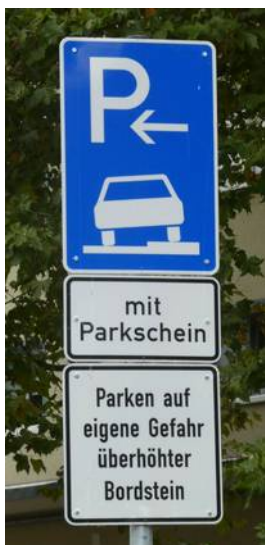
Bild 79: Bordsteine müssen ausreichend abgeschrägt und niedrig sein. Ein Warnhinweis reicht nicht aus.
