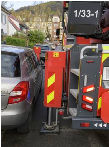
Bild 30: Dieser Falschparker verhindert das Ausfahren der Stütze (Stadt Heidelberg/Rothe)
