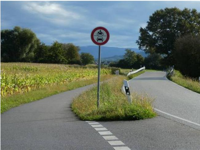
Bild 74: Mit Verkehrszeichen 260 versehene Nebenfahrbahn für Rad-, Reit- und Fußverkehr
