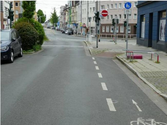
Bild 19: Ableitung des Radverkehrs auf den Gehweg
