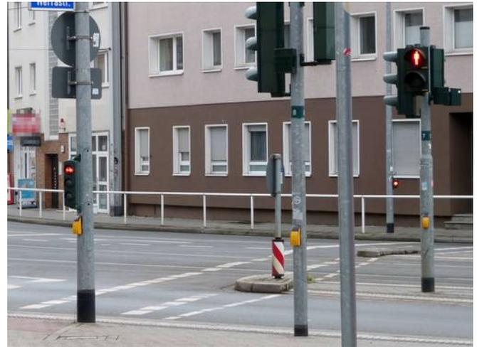
Bild 102: Separate Ampeln für die Fußgängerfurt und für den Radverkehr
