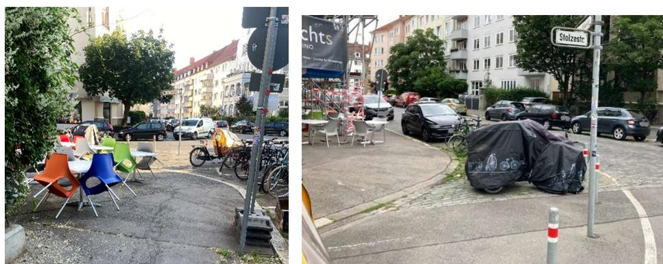
**Bild 53, 54:** Die Außenbestuhlung der Gastronomie reduziert die Gehwegbreite auf teilweise unter 1,40 m. Wir fordern eine fußwegfreundliche Umgestaltung. Lastenräder an Ecken führen zu Sichtbehinderungen ähnlich wie PKW.
